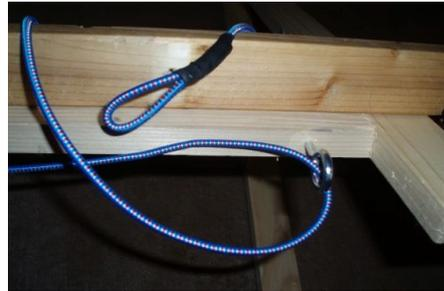
Die Ringschrauben werden von unten in eine untere Querstrebe des Bocks gedreht. Durch sie läuft später die Gummischnur.
