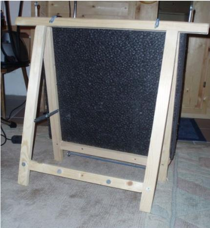
Die Holzleiste wird unten auf dem Bock befestigt. Sie dient als Auflage für die Scheibe. Bei einer runden Scheibe könnte eine geteilte Auflage zweckmäßiger sein.
